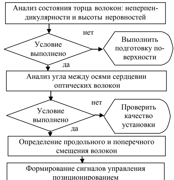
Рис.1. Схема последовательности контроля позиционирования оптических волокон
