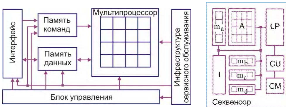
Рис. 7. Архитектура ЛАМП и структура УПУ
