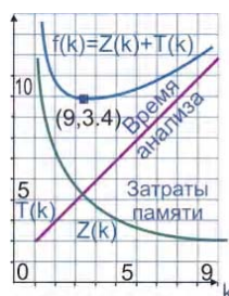
Рис. 5. Функции аппаратуры и времени от числа разбиений
