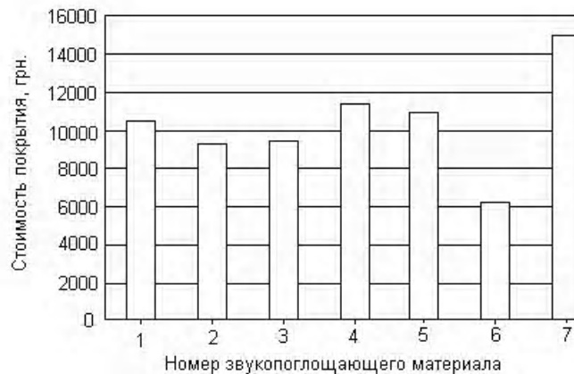
Рис. 4. Стоимость покрытий различными звукопоглощающими материалами: 1 – «Шуманет-БМ»; 2 – «URSA»; 3 – «Isover»; 4 – «Rockwool»; 5 – «Heraklite»; 6 – «Ecofone»; 7 – «Izolone»
