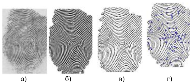
Рис.2. Этапы обработки изображения: а) – исходное изображение, б) – изображение после улучшения качества, в) – изображение после утончения линий, г) – изображение с минуциями
