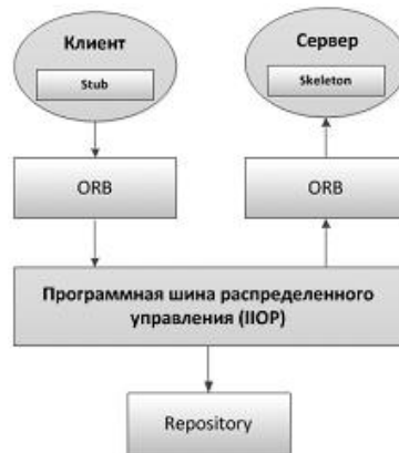
Рис. 1 – Структура распределенного управления сетью на базе CORBA
