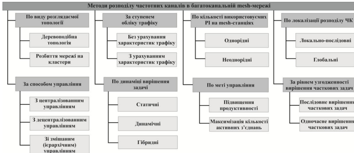
Рис. 1. Класифікація методів розподілу частотних каналів в багатоканальних mesh-мережах
