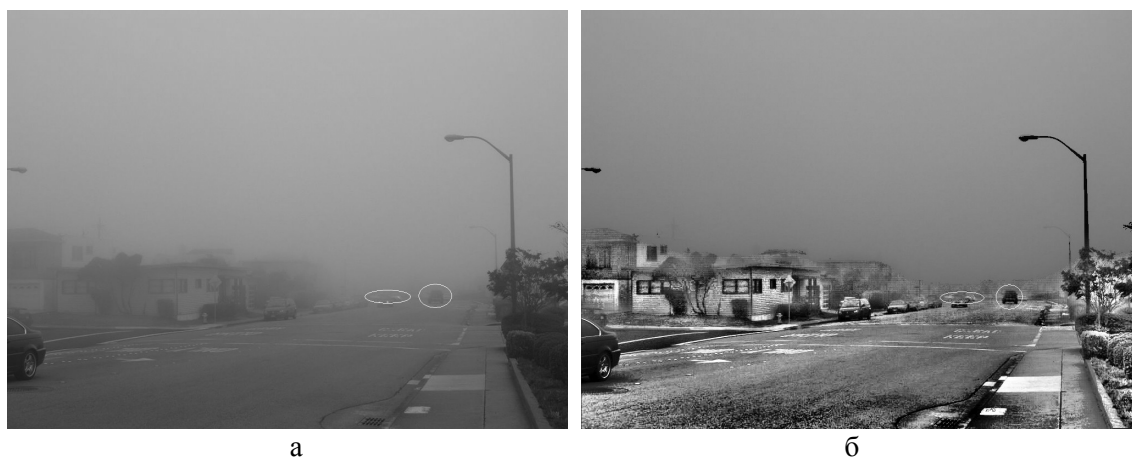
Рис. 1 — Результат контрастной коррекции цифрового ТВ изображения с применением метода адаптивной гистограммной эквализации (а — исходное изображения; б — обработанное изображение)
