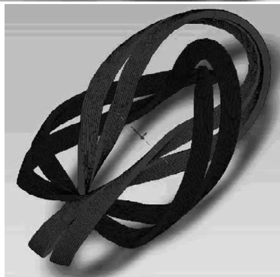
Рис. 1. Трехмерная геометрическая модель ВО торсатрона Урагана-2М
