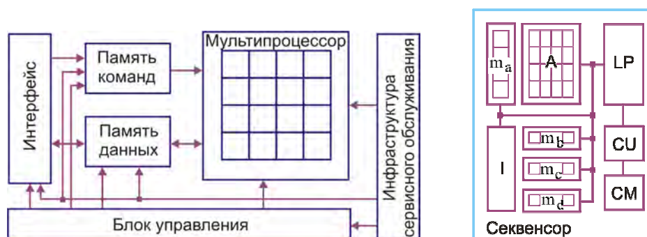
Рисунок 4.5 – Архітектура ЛАМПІ і структура УПУ
