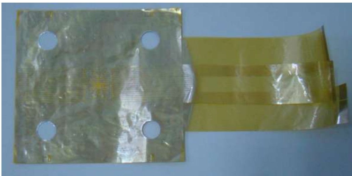
Рисунок 1.20 - Опытный образец прижимающей пластины (контактная сторона).
