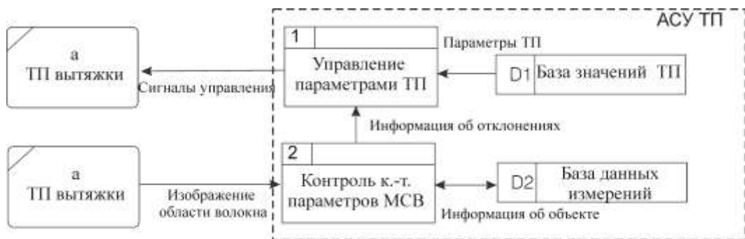
Рисунок 2.12 – Инфологическая модель процесса управления ТП вытяжки МОВ
