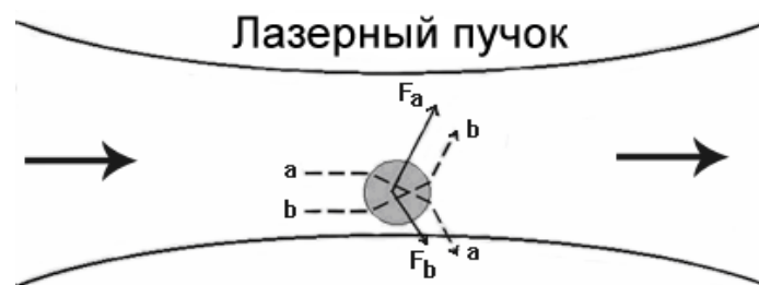
Рисунок 2.4 - Схема виникнення радіальних сил захоплення [49]
