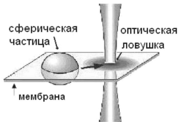
Рисунок 2.24 - Схематическое изображение эксперимента с визначення коефіцієнта в'язкості штучної мембрани
