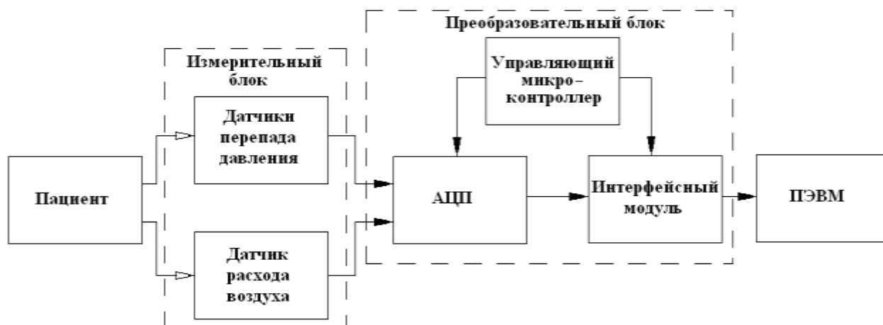
Рис. 1.8 Структурная схема риноманометра КРМ ТНДА
